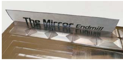
▶ 2h 연속가공 후 Ra(\mu\text{m}) = 0.057
